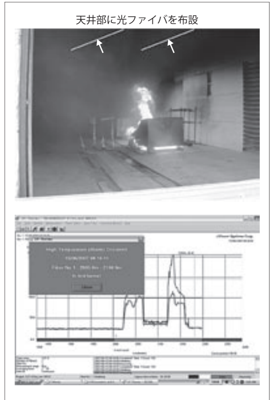
図表—12 トンネル火災の実験例
